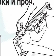
Прокладка вакуумного отделения Паз для крепления прокладки вакуумного отделения
